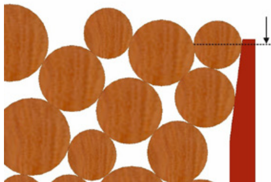
Stöttorna ska minst nå upp till mitten på det ytterst liggande virket.
