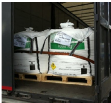
Exempel på grimma som hindrar säckarna att röra sig bakåt.
