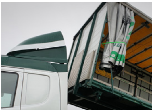
Typiskt slagprovad framstamskonstruktion.
