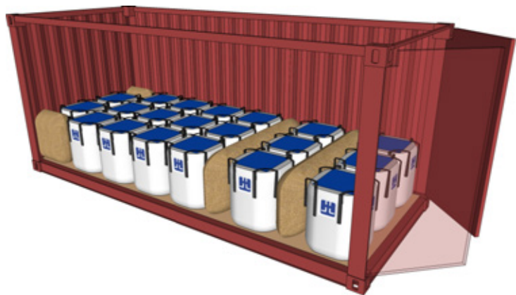
Exempel på storsäckar säkrade mot starka sidor genom utfyllnad med tompallar respektive luftkuddar.
