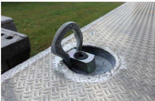
Exempel på typiskt surrningsfäste placerat längs kanten på flaket med styrkan 2000 daN (2 ton).
