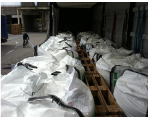
Exempel på storsäckar säkrade mot starka sidor genom utfyllnad med tompallar respektive luftkuddar.
