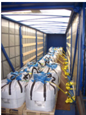
Exempel på säkring av storsäck med hjälp av överfallssurring.
